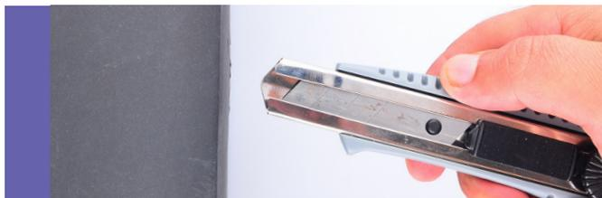
Ainsi, puisque le doigt n'actionne pas le curseur, **en fin de coupe**, c'est-à-dire lorsque la lame quitte la matière à couper, **la lame se rétracte automatiquement en toute sécurité**.
