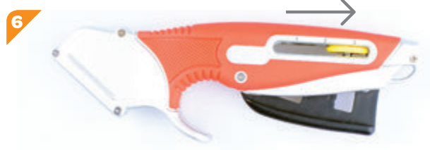
Il faut repositionner la molette en position 3 de travail et le couteau est prêt à l'emploi !
