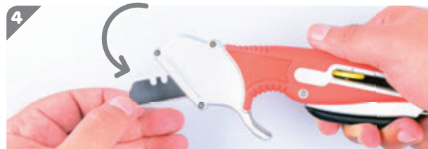
Continuez à garder la gâchette appuyée pendant que vous introduisez la nouvelle lame LSP 072 jusqu'à ce que la lame soit en butée.)
