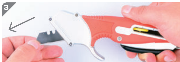
Extraire la lame usagée en tirant dessus
