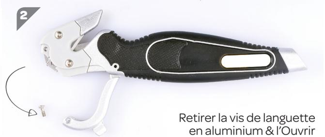
Retirer la vis de languette en aluminium & l'Ouvrir
