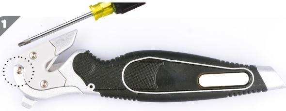
Se munir d'un tournevis & Dévisser la vis située sur la languette en aluminium
